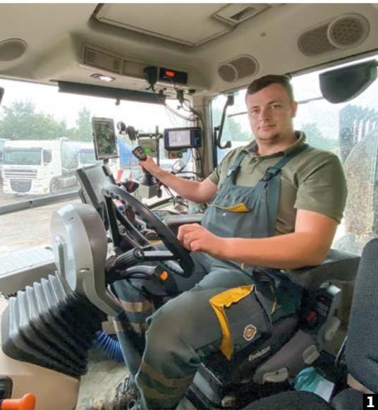
die ausgebrachte Menge auf dem Tablet, das sich in einer Halterung rechts neben ihm befindet. Alles im Soll-Bereich. Das Tablet ist einer von drei Monitoren. Hier werden die flächenbezogenen Daten aus einer Acker Schlagkartei angezeigt. Mit Hilfe der anderen beiden Monitore kann er die Funktionen des Güllefasses und die Betriebsdaten des Schleppers überwachen.
